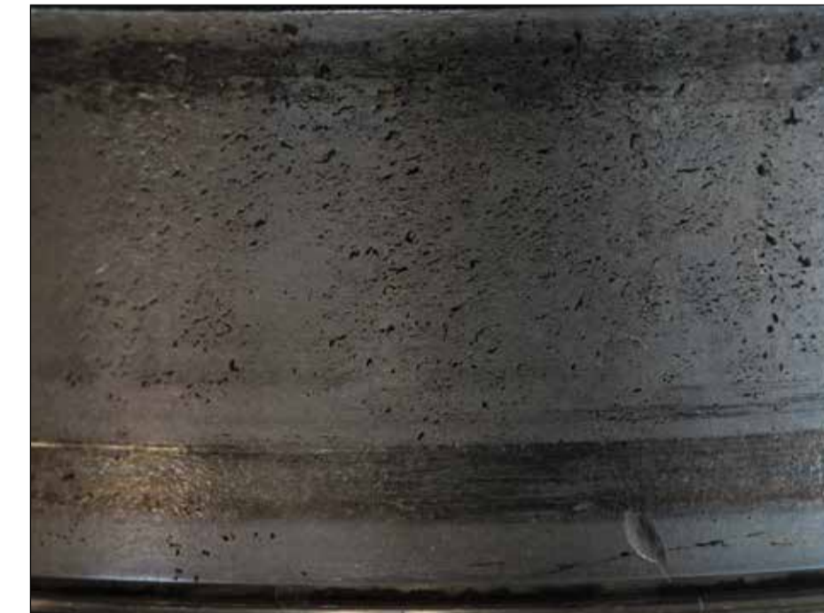
Unzureichende Schmierung/ Verunreinigung
