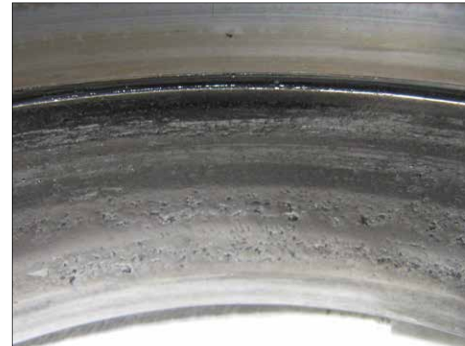
Vorzeitiger Ausfall des Radlagers
