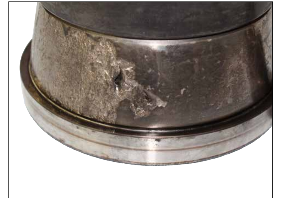
Übermäßige Vorspannung, Belastung
