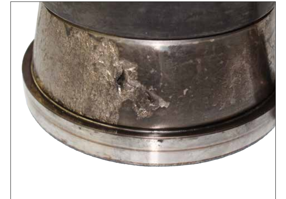
Übermäßige Vorspannung, Belastung
