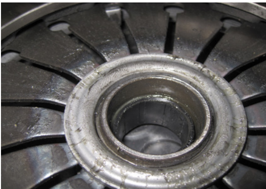
Bild 3: Fixierring des Ausrücklagers
