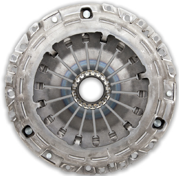
Bild 1: Druckplatte einer gezogenen Kupplung
